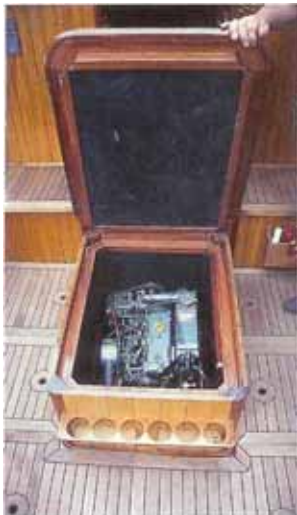
Bleiisolierung innen, genügend Gläserhalter außen - die Motorkiste im Cockpit.
